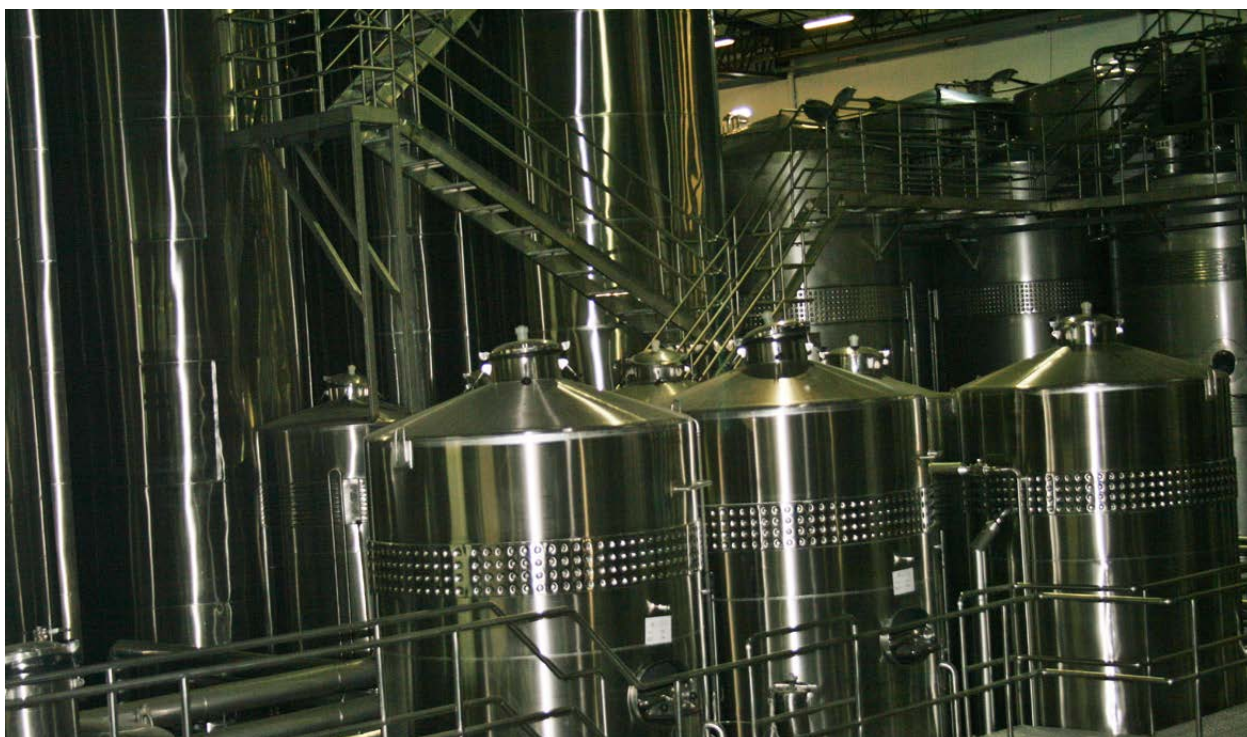
Método charmat na Vinícola Salton: tanques de inox, chamados de autoclave para a segunda fermentação do vinho espumante
