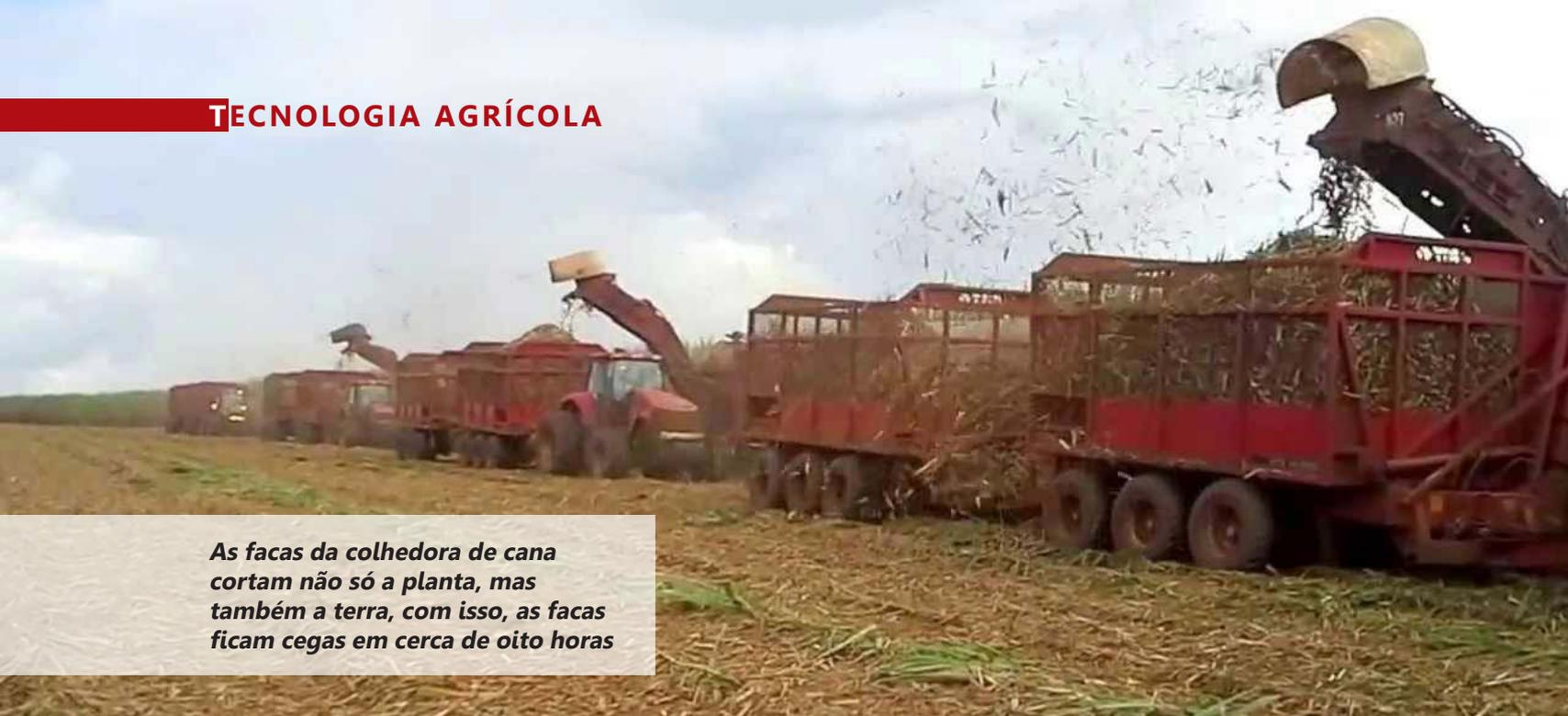
**As facas da colhedora de cana cortam não só a planta, mas também a terra, com isso, as facas ficam cegas em cerca de oito horas**
